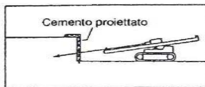
Installazione dei chiodi
